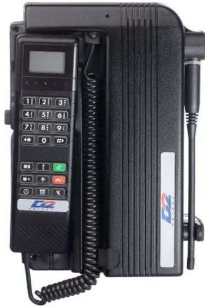
Motorola International 1000: das erste GSM-Mobiltelefon des US-Herstellers war in Deutschland für mehr als 3.000 Mark erhältlich. Es wog mehr als zwei Kilo, galt aber dennoch als „portabel“ – man konnte ja den Koffer aus dem Auto tragen.
