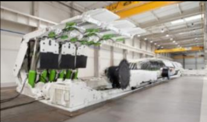
Automatisierte Maschine für den Kohleabbau unter Tage, Quelle: Famur Group
